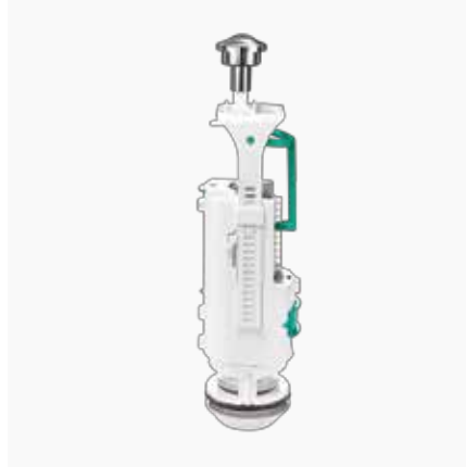
GEBERİT MARKA İÇ TAKIM GEBERİT marka iç takım 2,5-4,5 Lt. ayarlı olarak rezervuara monte edilmektedir. Rezervuarın klozete montajı, direk rezervuar içinden yapılmaktadır. Bu sayede, olası iç takım arızalarında klozetin komple sökülmesi önlenir.
