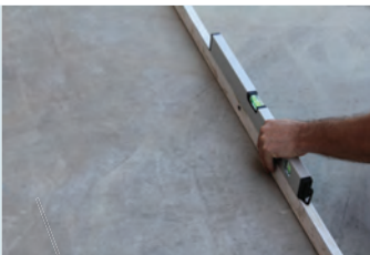
Yüzeyin düzgünlüğünün kontrol edilmesi
