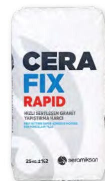
C001205 CERAFIX RAPID Çimento Esaslı Hızlı Sertleşen Granit Yapıştırma Harcı Fast Setting Super Adhesive Mortar For Porcelain Tiles 25kg Torba / Bag 48 Torba / Bags - Palet Sınıf / Class: C2FT
